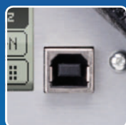
Actualización de firmware a través del interfaz serie (USB) trasero
